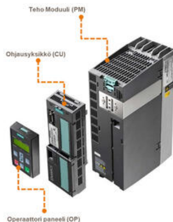
G120 taajuusmuuttajan modulaarinen rakenne
